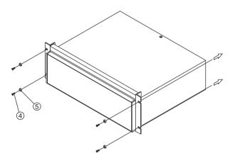
⚠注意 機器が落下する恐れがあります。 使用するラックに適合したサポートアングルを 取り付けて、本体を支持してください。
