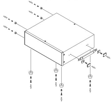
2. 付属のねじを使用してブラケットを図のように取り付けます。 付属のねじ(M4 x 10 皿ねじ)以外は使用しないでください。
